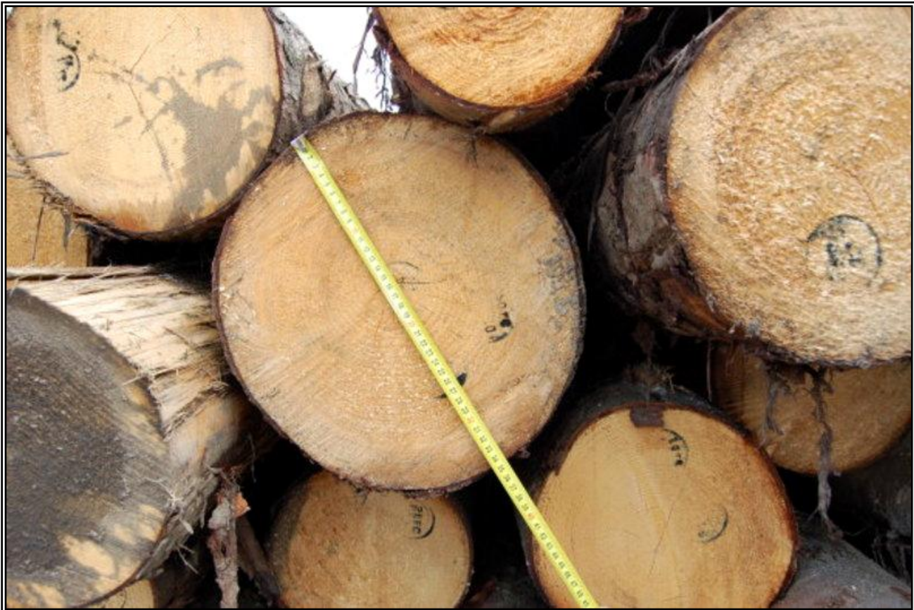
Przykład pomiaru kłód (najmniejsza średnica górna, bez kory, pomiar metrówką)
